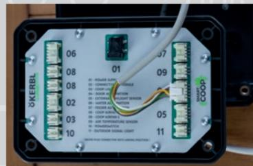
Sollte das am Modul verbaute Anschlusskabel in der Länge nicht ausreichen, so kann es mittels Verlängerungskabel (Art. 70633, 70634) verlängert werden. Achten Sie darauf, dass die Verbindungsstelle vor Wasser und Staub geschützt ist! Das Modulkabel darf max. 1x verlängert werden.
