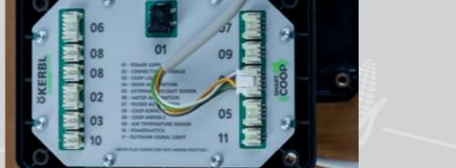
6. Montez le couvercle du boîtier avec les quatre vis à six pans creux.
