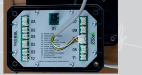
Se la lunghezza del cavo di collegamento installato nel modulo non è sufficiente, il cavo può essere allungato con una prolunga (art. 70633, 70634). Accertarsi che il punto di collegamento sia protetto dall'acqua e dalla polvere! Il cavo del modulo può essere allungato al massimo 1 volta.
