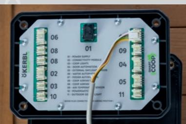
Si la longueur de câble de connexion raccordé au module n'est pas suffisante, servez-vous d'une rallonge (Réf. 70631, 70632). Veuillez à la protection du point de connexion contre l'eau et la poussière ! Un rallongement du câble n'est admissible qu'une seule fois.
