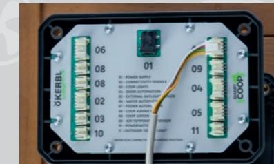
Se la lunghezza del cavo di collegamento installato nel modulo non è sufficiente, il cavo può essere allungato con una prolunga (art. 70631, 70632). Accertarsi che il punto di collegamento sia protetto dall'acqua e dalla polvere! Il cavo del modulo può essere allungato al massimo 1 volta.
